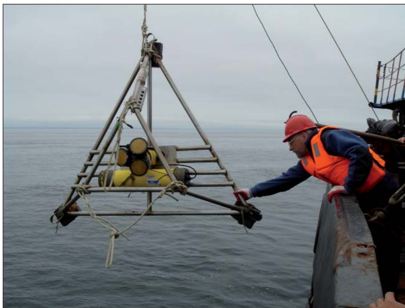
Фото 2. Подъем буйковой станции Photo 2. Lifting of the buoy-based station
