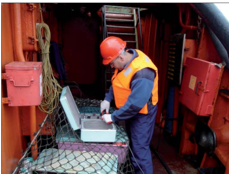
Фото 1. Работа с бортовым блоком размыкателя буйковой станции
